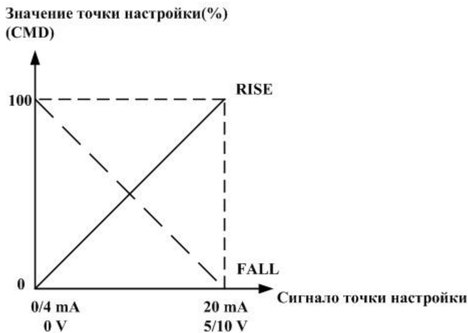
Изображение 24. Принципиальная схема DIR CMD
