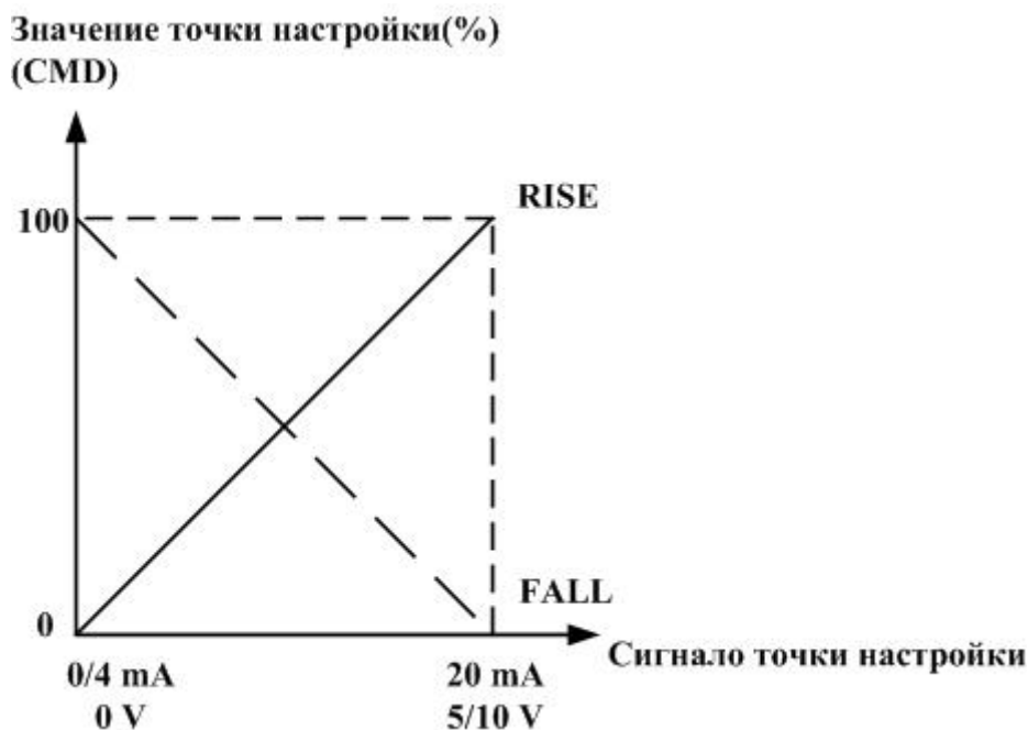
Изображение 21. Принципиальная схема DIR CMD
